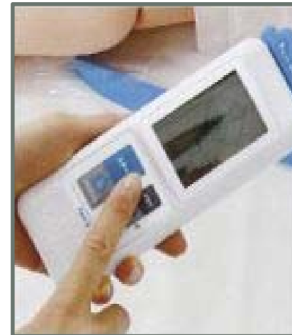
⑥スタートボタンで測定開始。12秒後に最高値のパッド番号グラフが点滅。最高圧表示。
